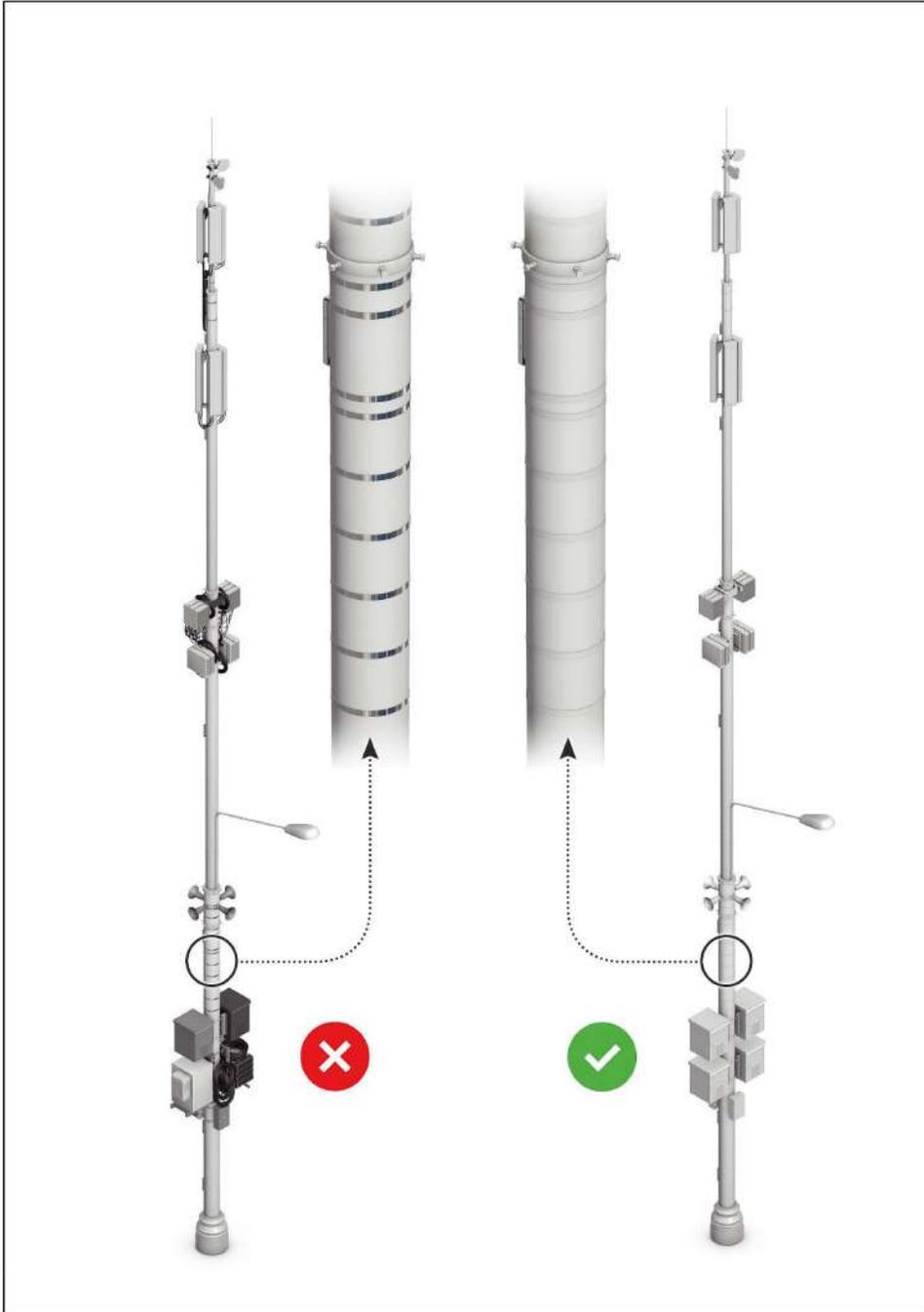
Рисунок 3. Симметричное размещение оборудования на опоре двойного назначения
