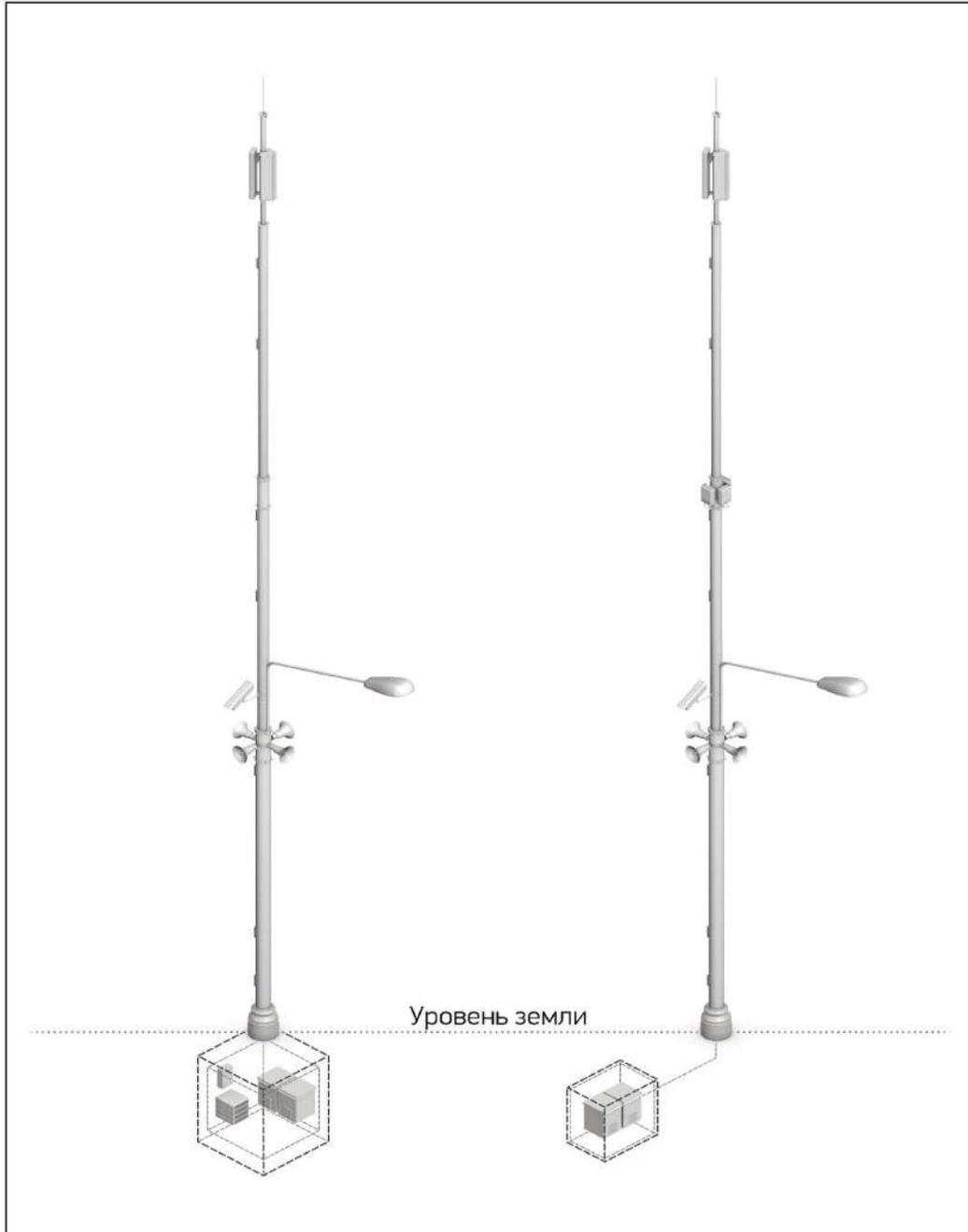
Рисунок 11. Размещение части оборудования базовой станции вне опоры двойного назначения, на улице в специальных термошкафах и малых архитектурных формах
