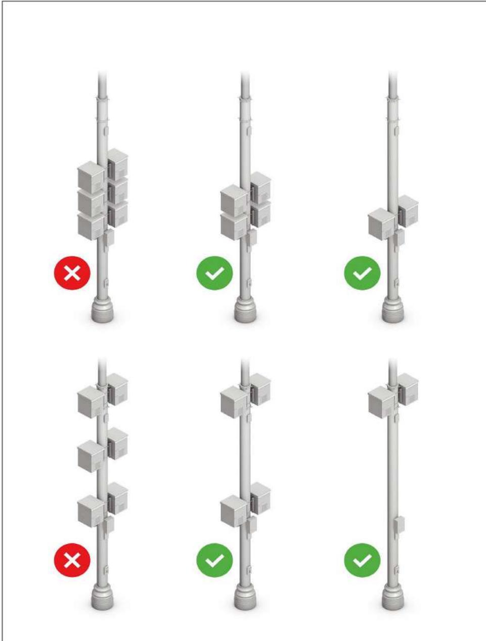
Рисунок 5. Ограничение по количеству термощкафов на опоре двойного назначения высотой менее 16 метров
