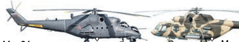
Mi-24 (по классификации НАТО — Hind — «Олень»), ударный вертолет огневой поддержки, второй в мире по количеству выпущенных машин. Максимальная взлетная масса 11 500 килограммов, экипаж — 2-3 человека. В войсках имеет прозвище «Крокодил». Дальность полета до 1000 километров, скорость 335 километров в час. Встроенное стрелково-пушечное вооружение в зависимости от модификации, число точек подвески — 6, подвесное стрелково-пушечное вооружение. Бомбы и кассеты калибром от 50 до 500 кг.
