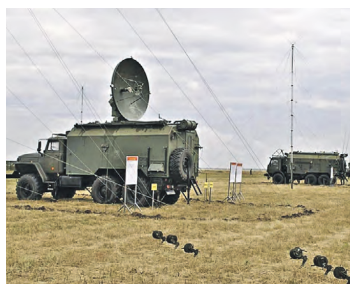
Комплексы радиоэлектронной борьбы «Поле-21» глушат GPS-сигналы, сбивая вражеские снаряды с намеченного курса
