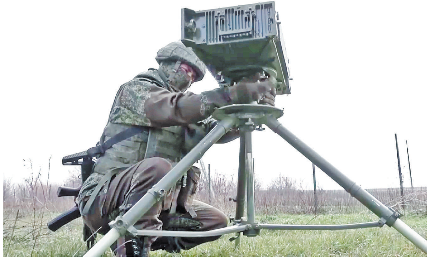
На этом снимке — расчет переносного комплекса разведки и контроля стрельбы «Аистенок» в боевой работе. В ходе спецоперации такая техника используется для контрбатарейной борьбы.
