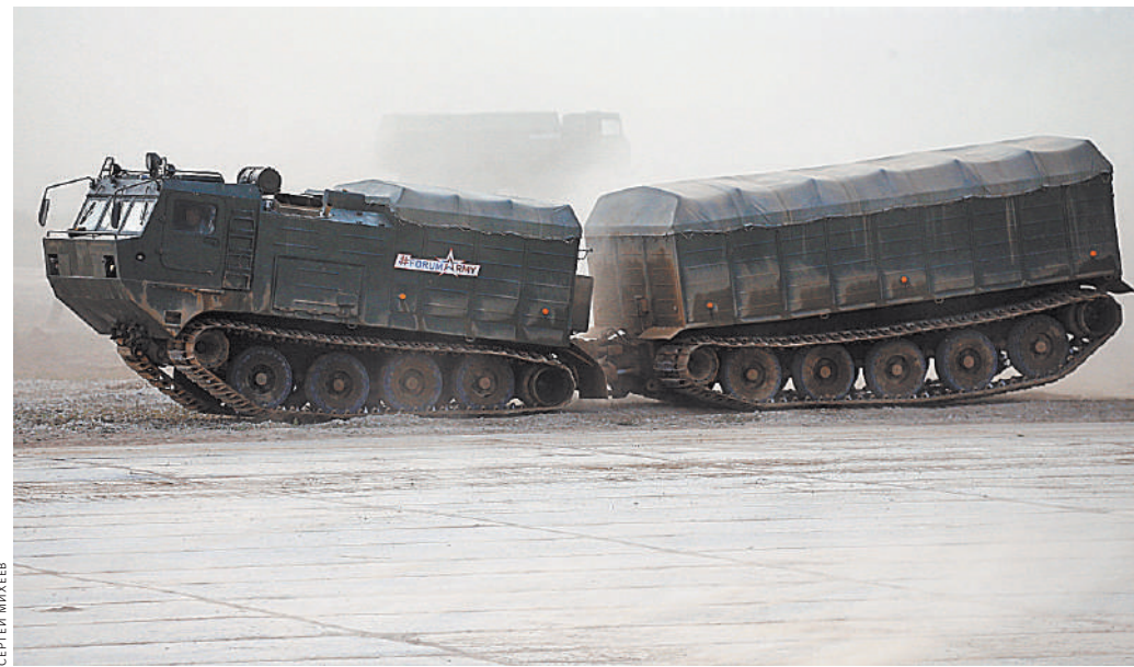
ДТ-30 способны перевозить в условиях полного бездорожья практически любые грузы массой до 30 тонн.
