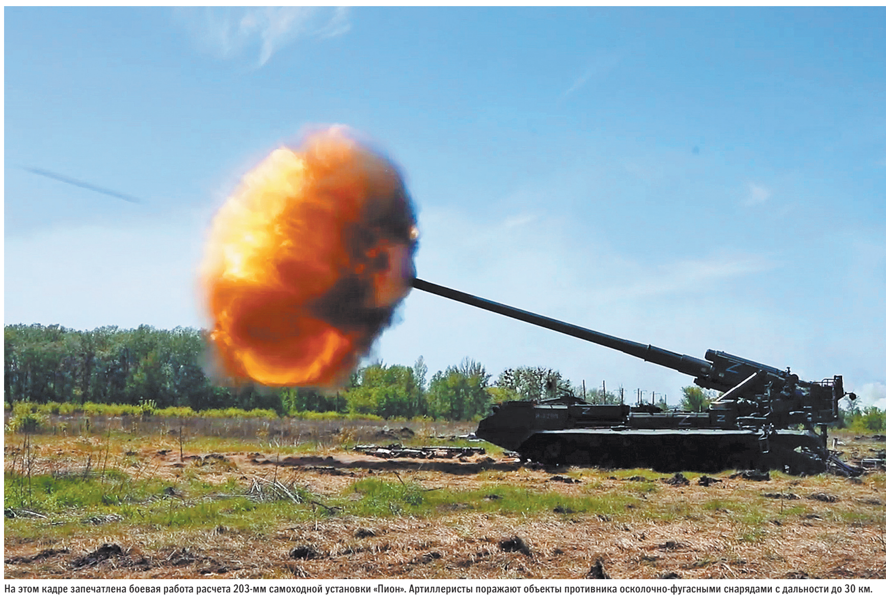
На этом кадре запечатлена боевая работа расчета 203-мм самоходной установки «Пион». Артиллеристы поражают объекты противника осколочно-фугасными снарядами с дальности до 30 км.
