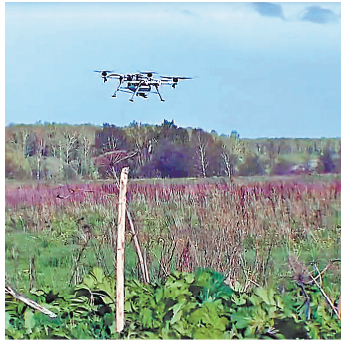
Дрон способен поднимать в воздух до 10 литров препарата.
