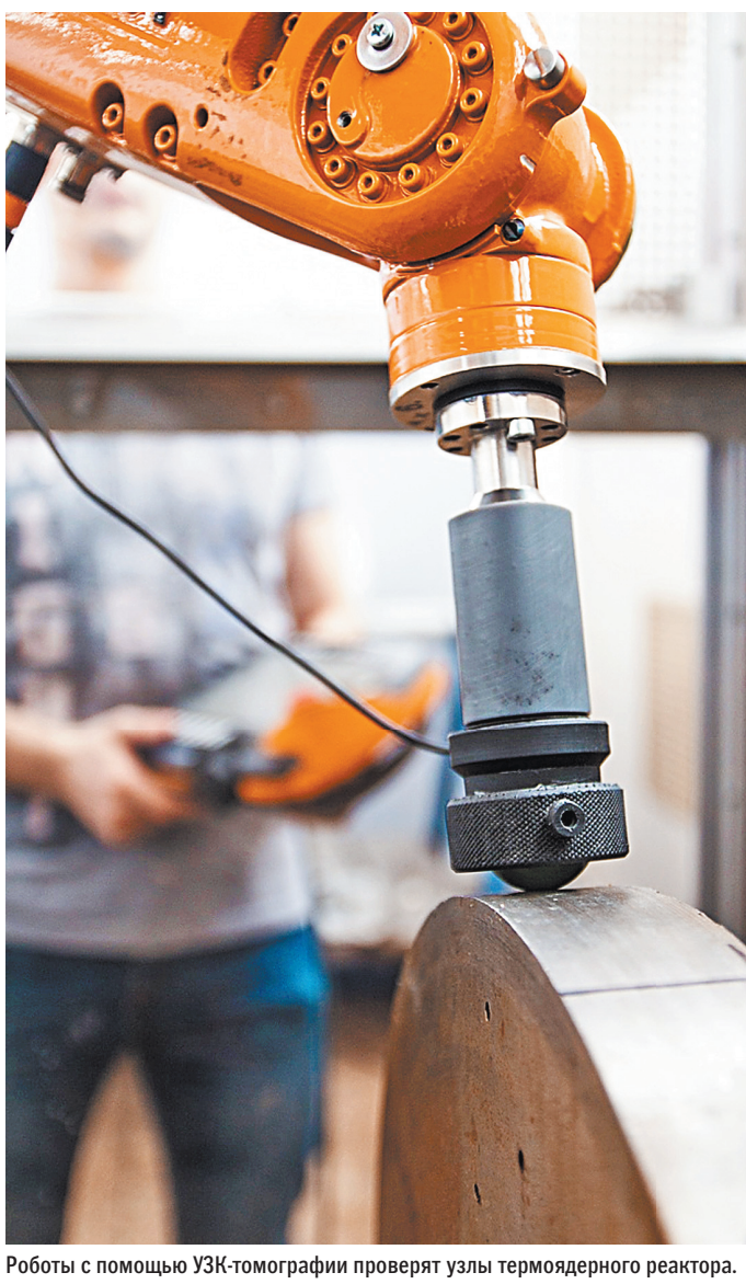
Работы с помощью УЗК-томографии проверяют узлы термоядерного реактора.
