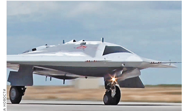
Серо-белый камуфляж «Охотника» выполнен по технологии «стелс», т.е. делает дрон практически невидимым на радаре.
