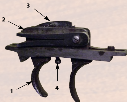
Немецкий шнеллер При нажатии на крючок взведения шнеллера (1) нагнетается очень сильная пружина шнеллера (2) и передняя часть его спускового рычага (3) своей зарубкой входит в зацепление со спусковым крючком; 4 – регулировочный винт
