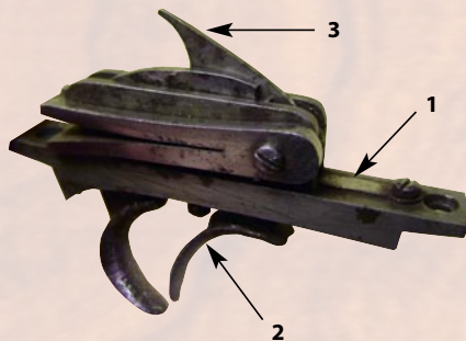
Немецкий шнеллер: 1 – спусковая пружина; 2 – спусковой крючок; 3 – спусковой рычаг, выполненный заодно со спусковым крючком
