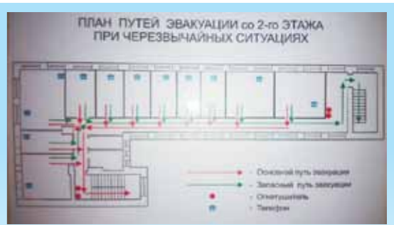
План, демонстрирующий пути спасения из небольшого офисного помещения, явно был подготовлен не профессионалом: эксперт выделил на нем несколько очевидных грубых нарушений. — На плане нет адреса объекта и/или его названия, — отмечает Григорьев. — Это имеет значение при вызове по телефону специальных служб при возникновении ЧС. Телефонных экстренных служб на плане, впрочем, также нет — как и описания действий при пожаре и обозначения места, где находится читающий план.
