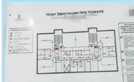
План, составленный которого требования ГОСТа выполнялись сугубо формально. В результате даже при дневном или искусственном свете разглядеть на нем обозначения практически невозможно. — План выполнен на бумаге под фотолюминесцентной пленкой, — комментирует Григорьев. — Из-за такой технологии не видно ярких красок, а тонкие линии плохо различимы.
