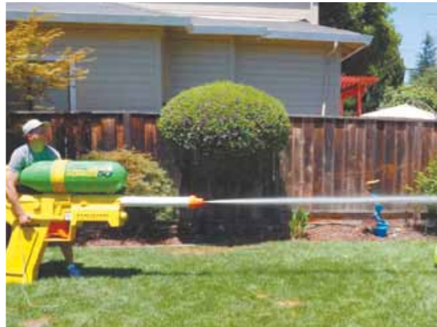
Американский инженер, бывший сотрудник NASA, а теперь популярный видеоблогер Марк Робер создал самый большой в мире водяной пистолет. Его рекорд уже подтвержден специалистами Книги рекордов Гиннеса. Пистолет оснащен двумя баллонами — с водой (вместает 7,5 литра) и сжатым азотом. При нажатии на спусковой крючок, роль которого играет расположенная сбоку кнопка, высвобождается газ, который попадает в баллон с водой, а та в свою очередь «выстреливает» со скоростью 437 км/ч.
