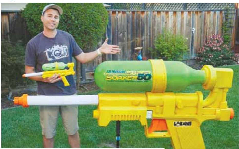
Американский инженер, бывший сотрудник NASA, а теперь популярный видеоблогер Марк Робер создал самый большой в мире водяной пистолет. Его рекорд уже подтвержден специалистами Книги рекордов Гиннеса. Пистолет оснащен двумя баллонами — с водой (вместает 7,5 литра) и сжатым азотом. При нажатии на спусковой крючок, роль которого играет расположенная сбоку кнопка, высвобождается газ, который попадает в баллон с водой, а та в свою очередь «выстреливает» со скоростью 437 км/ч.
