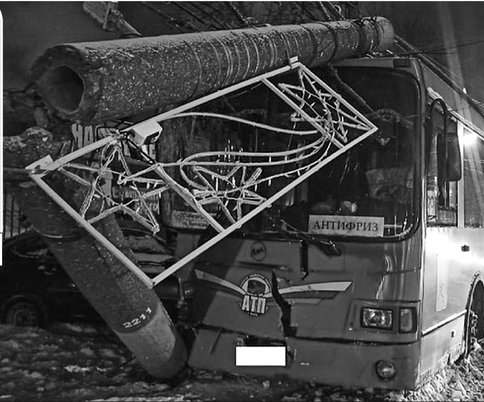
Опора линии электропередач сломалась после столкновения.
