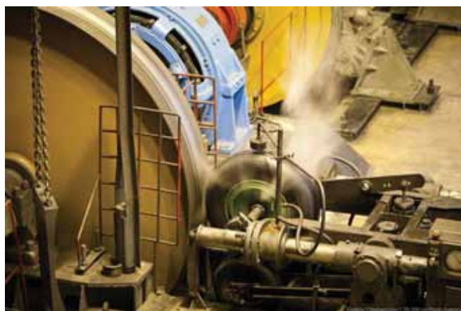
Стенды, где имитируют скорости и нагрузки на колесо при взлете и посадке самолета
