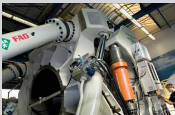
Процесс тестирования подшипника, используемого в конструкции ветряного электрогенератора.
