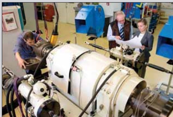
Испытательный стенд для подшипников, устанавливаемых в ж/д транспорт.
