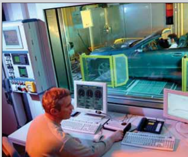
Тестовый участок. Замеряется уровень шума подвески автомобиля.
