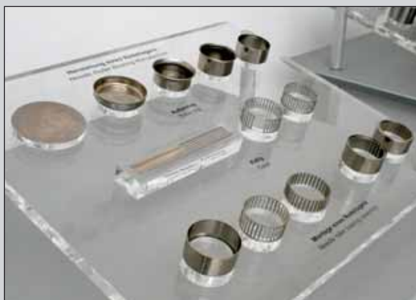
Методом штампования и вытягивания из листового металла производятся сепараторы и внешняя обойма для игольчатых подшипников.
