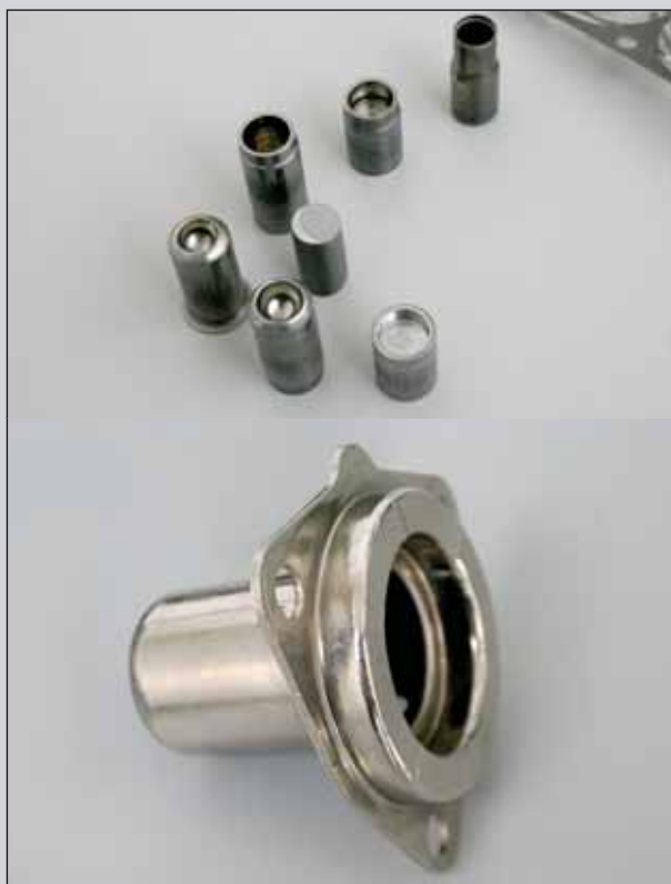
Требуется всего несколько ударов пресса, чтобы из куска металлического стержня получилась готовая деталь.
